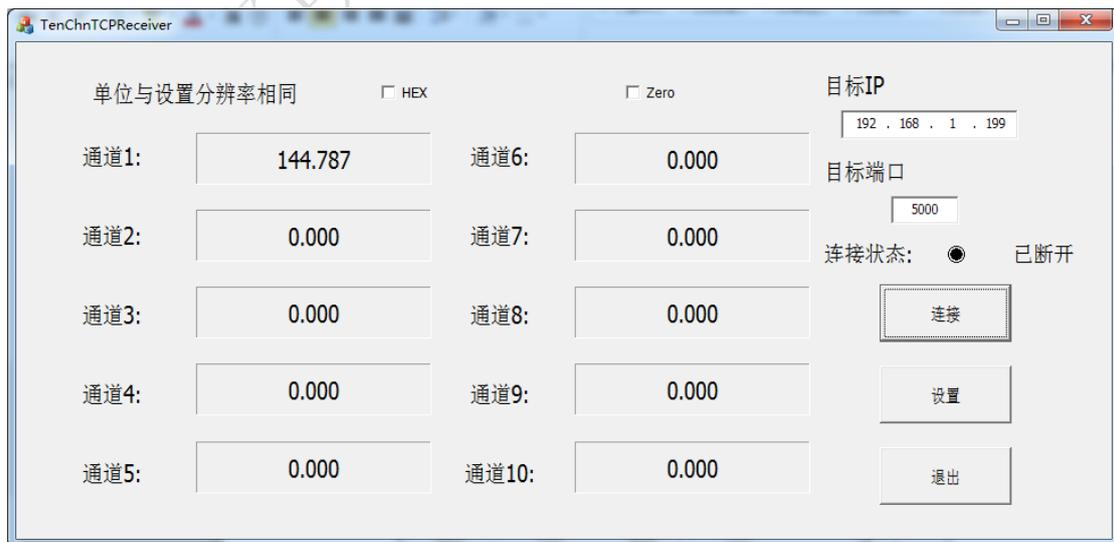
2、勾选 HEX 为 16 进制显示,不勾选为 10 进显示。勾选 Zero 为选定归零显示,设置 0 参考点,后续介绍使用方法。
