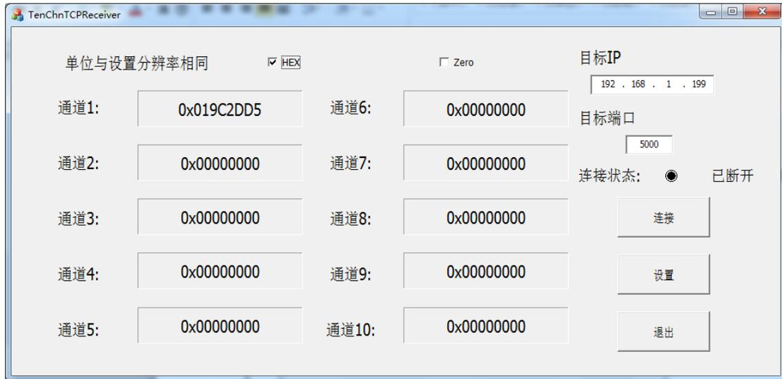
3、点击设置可进行分辨率、归零位置和编码器位数设置。其中分辨率代表 位置/每码值，例如：编码器为直线式，每个码值代表 1um，则设置为 1um 后主页面以 um 为单位显示，若为圆型编码器，编码器位数为 26 位，则每个码值代表  $360/2^{26}$  度，设置为 0.00000536 后主页面以 ° 为单位显示。
